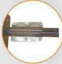
Galvaniz yem boruları 6 vidalı boru bağlantıları ile birleştirilerek hattın düz durmasını sağlar ve boruların dönmesini engeller. Sistemin verimli bir şekilde çalışabilmesi ve iyi performans sergileyebilmesinde etkili rol oynar.
