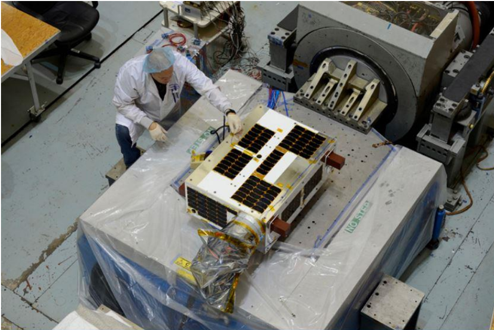
NEOSSat se está preparando para las pruebas de vibración en el Laboratorio David Florida ubicado en Ottawa, Ontario. Las pruebas de vibración simulan la vibración durante el lanzamiento del satélite. NEOSSat es un microsatélite de doble misión diseñado para detectar asteroides potencialmente peligrosos que cruzan la órbita terrestre y rastrear objetos que residen en el espacio profundo. También es la primera implementación del bus microsatélite multimisión genérico de Canadá. (Crédito: Janice Lang, DRDC )
