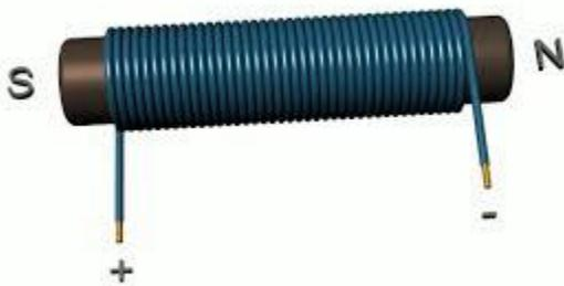
Cuando hablamos de un electromagneto (electromagnetismo...¿recuerdan que lo mencioné?), que es simplemente un “coil” de alambre con un nucleo de hierro por ejemplo, diseñado para crear un campo magnético se acostumbra a usar la unidad At (vuelta-amperio). Un alambre doblado en círculos y cargando 1 amperio de corriente, producirá por definición 1At de fuerza magnetomotriz. El gilbert (Gb) es la unidad utilizada ocasionalmente para
