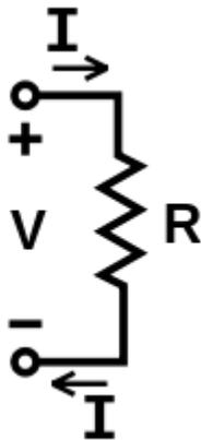
La corriente en un circuito con resistores en serie no cambia. La corriente (I) que entra será en este circuito será la misma que sale. El voltaje = (I)(R)
