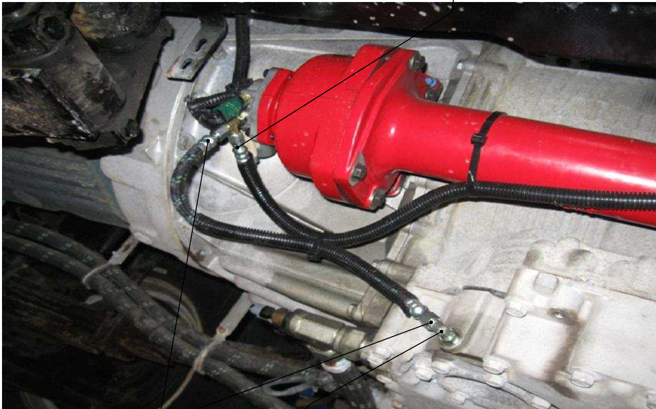
BRANCHEMENT ALIMENTATION D'HUILE EN PRESSION A PARTIR DE LA TRANSMISSION
