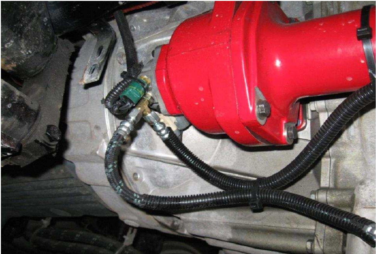
BRANCHEMENT POUR LUBRIFICATION DES SPLINES DE LA POMPE
