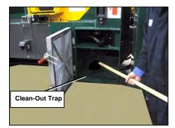
Figure 48. Hopper clean-out trap door
