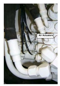
Figure 178. Air actuators
