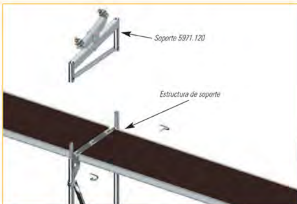
Detalle C: Soporte de la cubierta.
