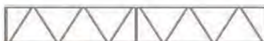
► Viga celosía de cubierta
