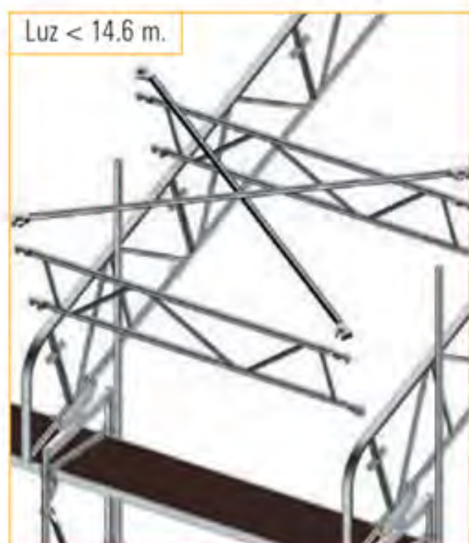
Conexión de diagonales en planta y de vigas transversales
