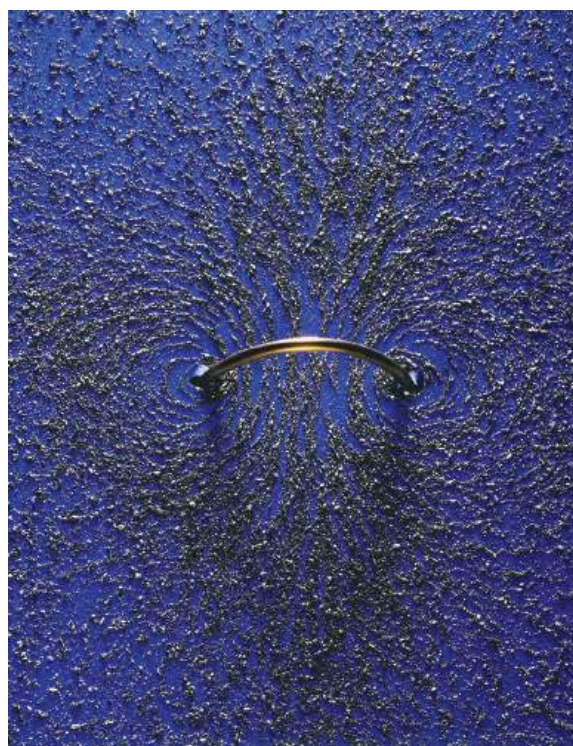
Linhas de campo magnético geradas por uma espira circular.
