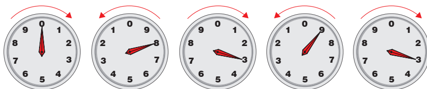
Medidor de energia - Tipo relógio
