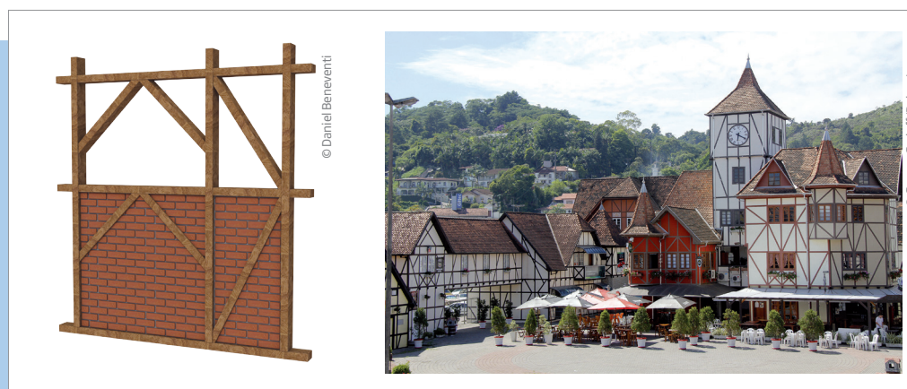
Esquema de parede em estilo enxaimel. Edifícios do centro de Blumenau (SC).
