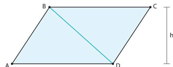
Para determinar a área de terrenos irregulares, os topógrafos utilizam uma técnica chamada **triangulação**. Nessa técnica, aproxima-se a forma do terreno à de um polígono e decompõe-se o polígono em triângulos, como mostram as figuras a seguir.
