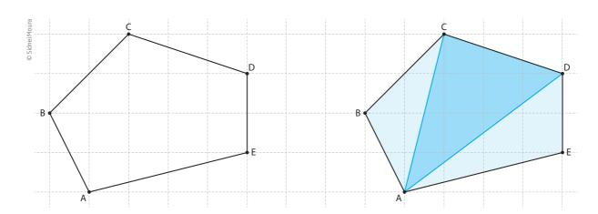
Para calcular a área dos triângulos, os topógrafos utilizam instrumentos de precisão, como o teodolito, que permitem determinar as medidas dos lados e dos ângulos dessas figuras. Eles utilizam fórmulas trigonométricas e programas de computador para determinar a área com a precisão desejada.
