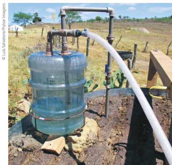
Galão de água utilizado no sistema biodigestor para a produção de gás natural.
