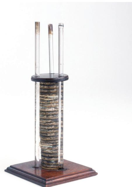
Pilha de Volta.
