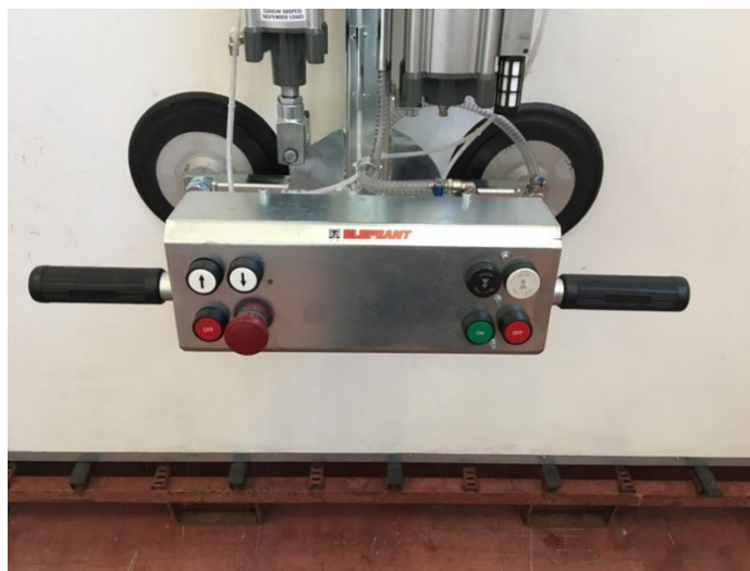
CAIXA DE COMANDO UNIFICADO
