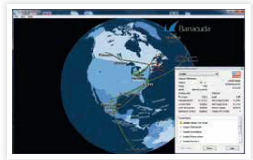
Barracuda Earth: el gráfico en tiempo real de la Utilidad de Monitoreo de red 3D del Barracuda Firewall Control Center, proporciona una visión general del estado de todos los túneles VPN sitio a sitio.
