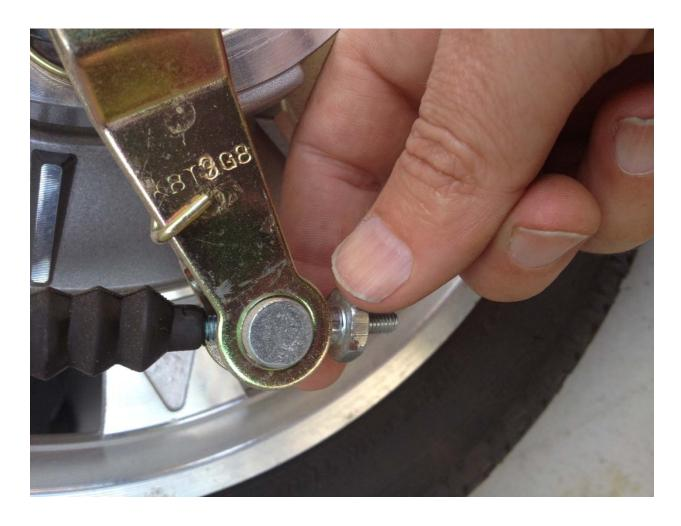
REMOVE THE BRAKE CABLE TENSIONING NUT. THIS WILL FREE THE CABLE FROM THE BRAKE DRUM LEVER.
