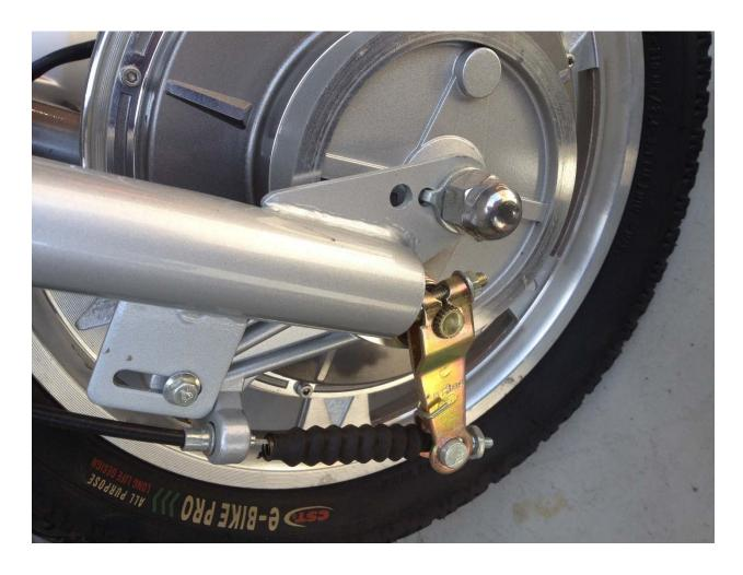
NOW GO TO THE OTHER SIDE WHICH HAS THE BRAKE CABLE AND BRAKE ASSEMBLY TO REMOVE.
