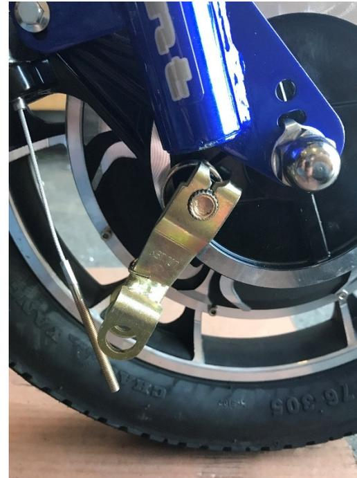
\*TAKE NOTE OF THE ANGLE OF THE LEVER PRIOR TO REMOVING IT SO YOU CAN REPLACE WITH THE FOOT BRAKE LEVER IN THE SAME LOCATION.
