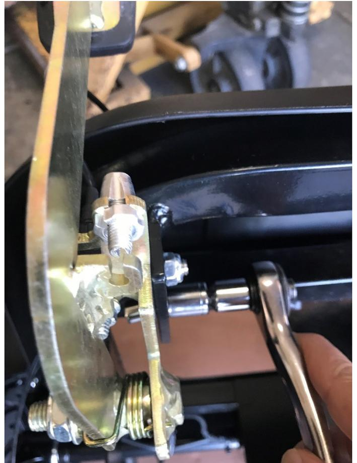
2. ONCE THE FOOT BRAKE ASSEMBLY IS SECURELY MOUNTED TO THE FRAME, CONNECT THE ELECTRICAL CONNECTOR OF THE FOOT BRAKE ASSEMBLY TO THE CORRESPONDING CONNECTOR OF THE FRAME WIRING HARNESS.
