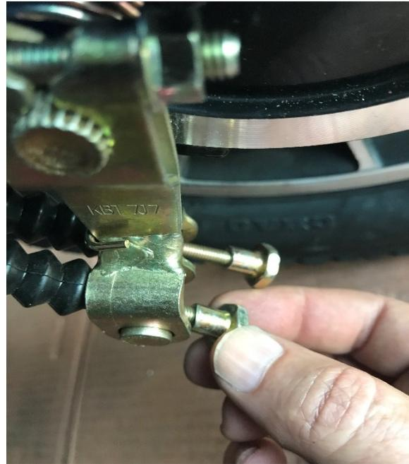
11. WRAP THE BACK END OF THE FOOT BRAKE CABLE AROUND THE FRONT OF THE HANDLE BAR MOUNTING TUBE PREPARING TO CONNECT THE BACK END OF THE FOOT BRAKE CABLE INTO THE FOOT BRAKE ASSEMBLY ANCHOR.
