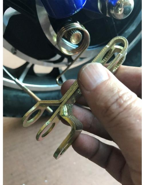
5. SLIDE ON THE NEW FOOTBRAKE DRUM LEVER IN THE SAME ANGLE THE OLD LEVER WAS SET AT AND INSERT TENSIONER SPRING IN SET HOLE ON THE BRAKE DRUM AND THE OTHER END SNAPS OVER THE NEW FOOT BRAKE LEVER. SECURE LEVER WITH BRAKE DRUM SET BOLT.
