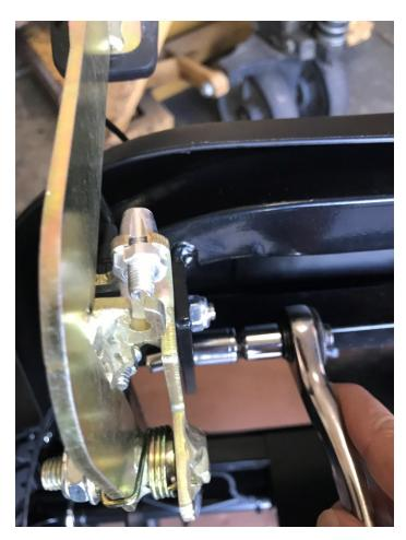
2. ONCE THE FOOT BRAKE ASSEMBLY IS SECURELY MOUNTED TO THE FRAME, CONNECT THE ELECTRICAL CONNECTOR OF THE FOOT BRAKE ASSEMBLY TO THE CORRESPONDING CONNECTOR OF THE FRAME WIRING HARNESS.
