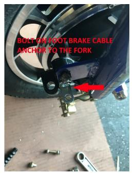
FORK BOLT PROVIDED AND SECURE WITH EXISTING NUT. THE BRAKE CABLE ANCHORS FOR BOTH THE HAND BRAKE AND THE FOOT BRAKE ARE NOW READY TO ACCEPT THE BRAKE CABLES.
