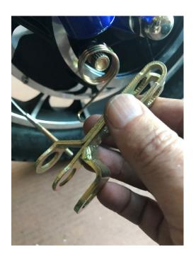
5. SLIDE ON THE NEW FOOTBRAKE DRUM LEVER IN THE SAME ANGLE THE OLD LEVER WAS SET AT AND INSERT TENSIONER SPRING IN SET HOLE ON THE BRAKE DRUM AND THE OTHER END SNAPS OVER THE NEW FOOT BRAKE LEVER. SECURE LEVER WITH BRAKE DRUM SET BOLT.
