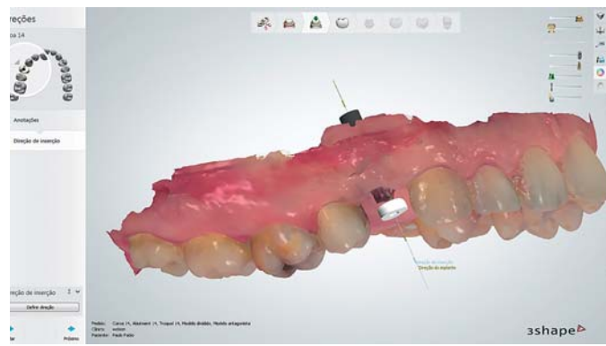
Figura 6 Determinação do espaço disponível para o intermediário e para a coroa protética.
