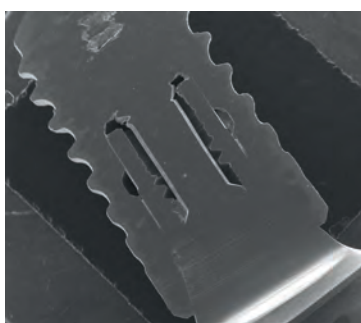
Fig 2 Imagem em MEV (Quanta 200, FEI, Hillsboro, OR, EUA) com aumento de 32X Munhão Preparável 1 mm EFF505.04.1A, EFF Denta Componentes, São Paulo - SP, Brasil
