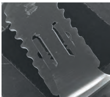
Fig 2 Imagem em MEV (Quanta 200, FEI, Hillsboro, OR, EUA) com aumento de 32X Munhão Preparável 1 mm EFF505.04.1A, EFF Dental Componentes, São Paulo - SP, Brasil
