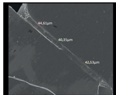
Fig 3 Imagem em MEV (Quanta 200, FEI, Hillsboro, OR, EUA) com aumento de 600x Munhão Preparável 1 mm EFF505.04.1A, EFF Dental Componentes, São Paulo - SP, Brasil
