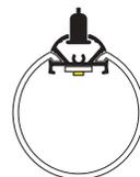
**Material** Kit de perfil de aluminio para mica curva, acabado natural para suspender de 2 m de largo, para recibir tira extraplana o tarjeta de LEDs
