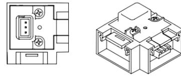
CONECTOR 90° ALINEACIÓN VERTICAL TERMINACIÓN CIEGA
