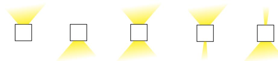
El ajuste manual de los ángulos de emisión de luz permite proyectar efectos personalizados en muros
