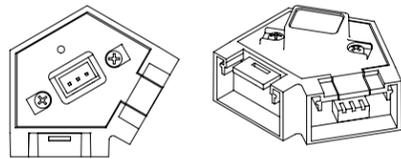
CONECTOR 60° ALINEACIÓN VERTICAL TERMINACIÓN CIEGA
