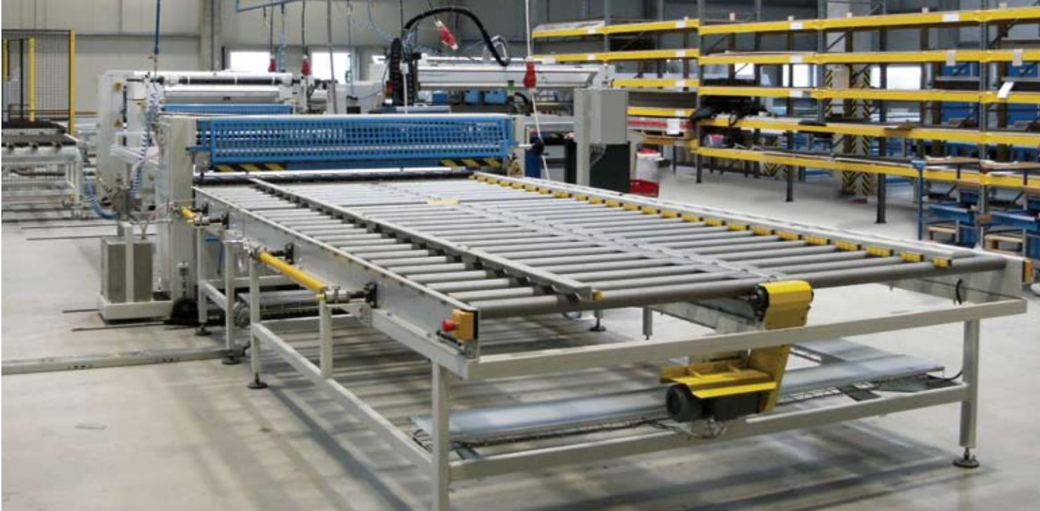
Hotmaster è il nostro miglior risultato dedicato specificatamente per applicazioni di colle termofusibili hot-melt. Sistema di riscaldamento interno dei rulli con olio diatermico indipendente per ciascuno
