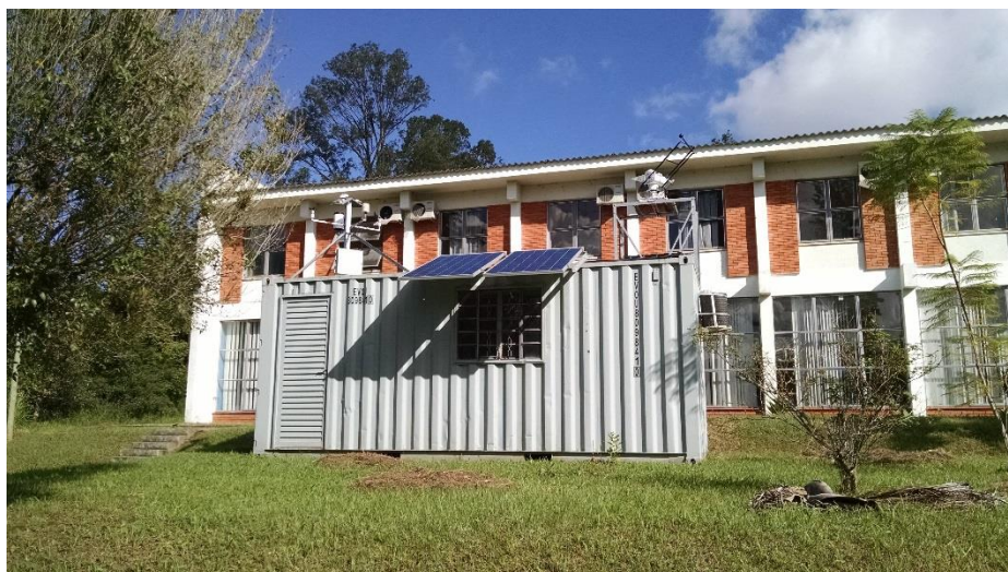
Figura 19 - Obstrução causada por construção ao sul da estação
