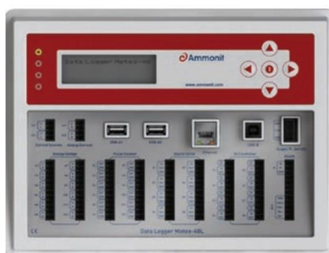
Figura 18 - Datalogger Ammonit Meteo-40
