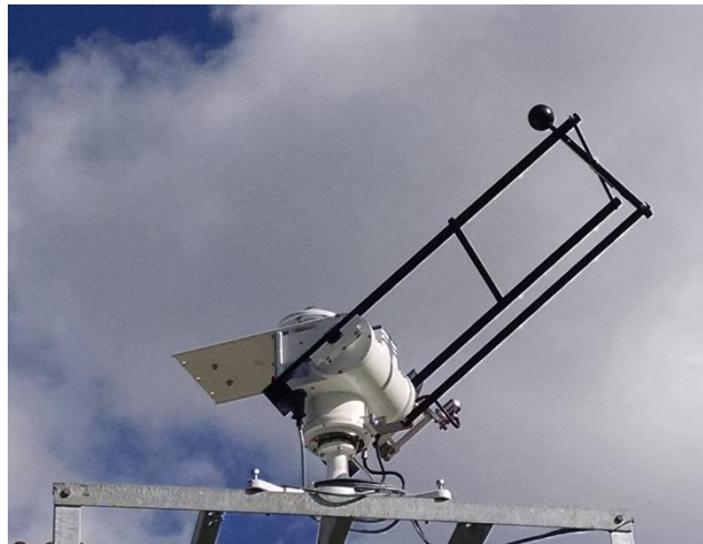
Figura 3 - Esquema de montagem de um piranômetro com esfera de sombreamento
