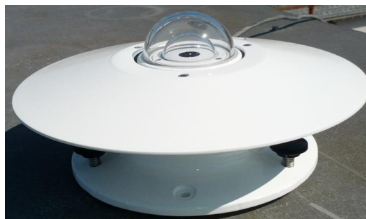
Figura 2 – Ilustração do piranômetro Eppley PSP Fonte: Eppley Lab (2017)
