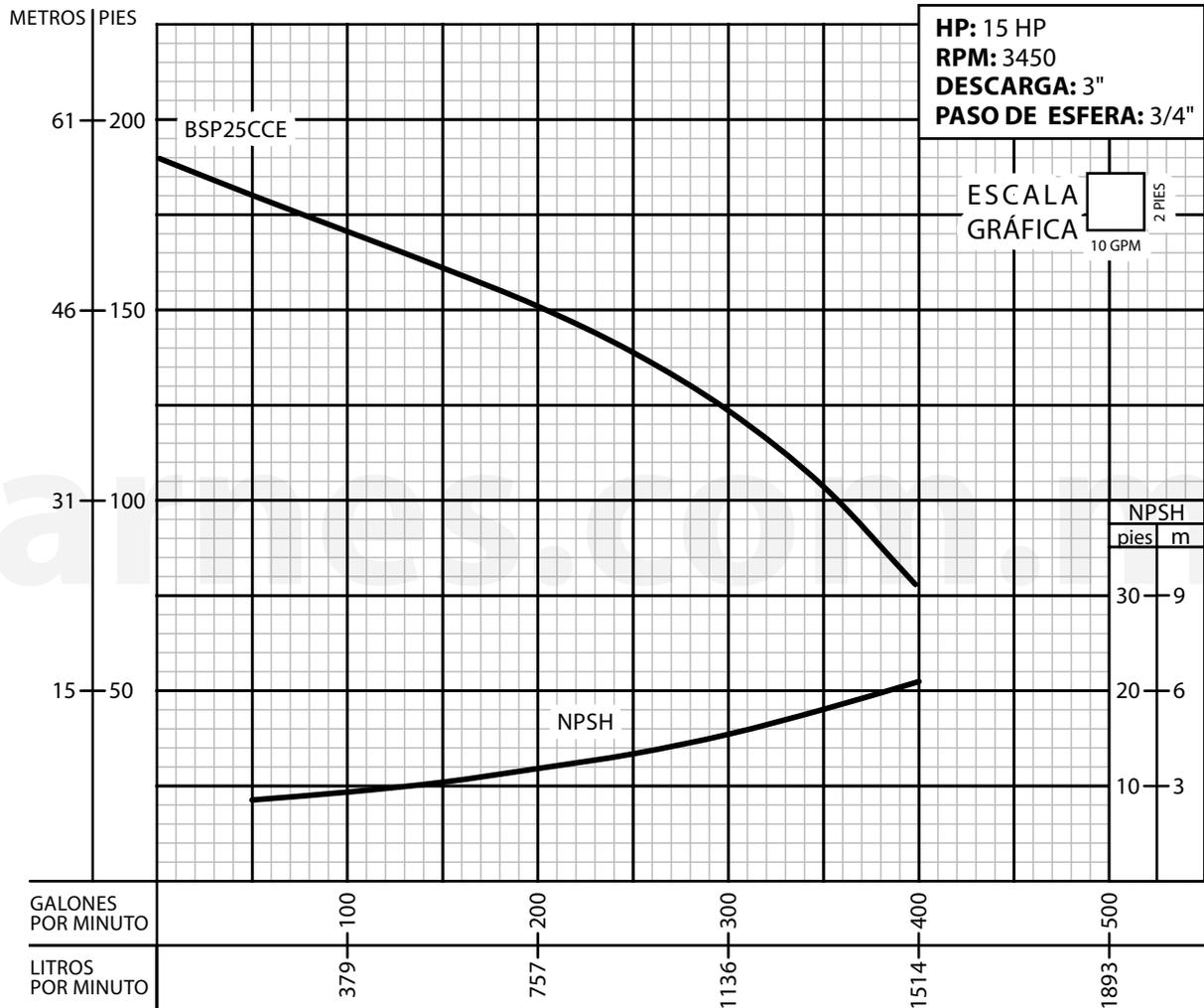
Prueba realizada con agua, gravedad específica 1.0 @ 20 °C (68 °F); otros líquidos pueden variar el rendimiento.
