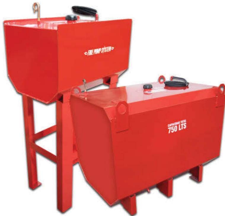
Este tipo de tanques se usa en equipos contra-incendio y se deben dimensionar en base a la Norma NPFA 20, que dice que el tanque de combustible deberá tener una capacidad como mínimo de 1 galón por HP y considerar 5% más por sedimentos y otro 5% por expansión.
