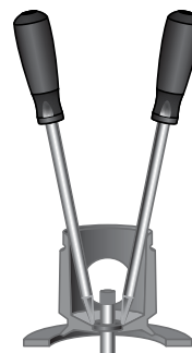
Figura 8: Remoción del sello mecánico
