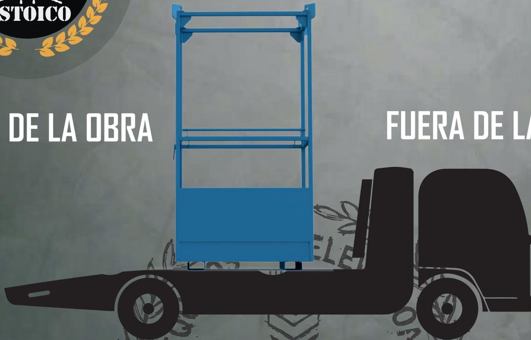
El equipo debe estar sujeta con bandas de seguridad para evitar desplazamientos o caídas de la unidad que la transporta
