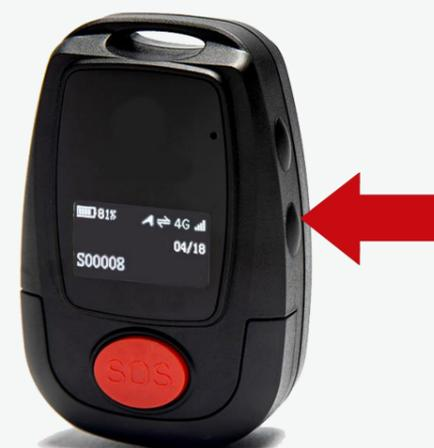
**Fermeture du DATI:** À la fin du quart de travail, fermez le DATI. Appuyez sur le bouton du bas sur le côté jusqu'à ce que vous entendiez un bip et la vibration. Par la suite, connectez le câble USB magnétique derrière pour chargement.
