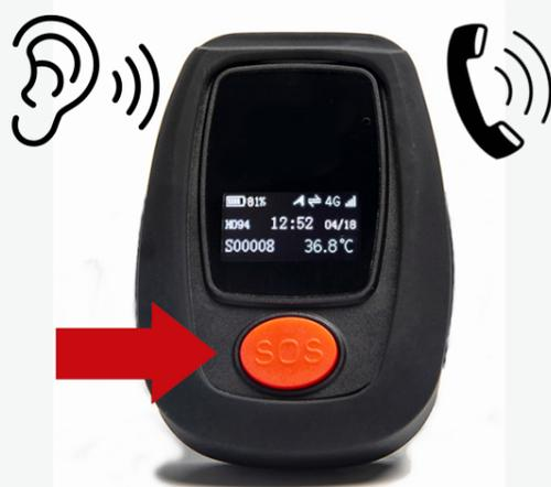
**Alerte SOS:** Appuyez le bouton SOS pendant 3 secondes. Vous entendrez un bip, une vibration et verrez l'indication SOS à l'écran, ce qui indique que l'alerte courriel et SMS est en cours. Si la connexion le permet, un appel au répondant s'effectuera.
