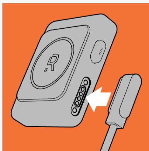
Connecter l'embout magnétique sur le côté du Laxson-R jusqu'à ce qu'il se colle.
