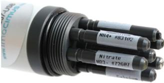
Los electrodos selectivos de iones de NT Sensors con nanotubos de carbono permiten nuevas posibilidades de muestreo in situ, con correlación a resultados de laboratorio.
