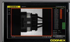
VisionView es un panel de visualización que permite capacitar, actualizar y supervisar rápidamente los trabajos en la línea de producción sin necesidad de una PC. Tener esta tecnología en la planta de producción mejora la eficiencia, facilita la administración sencilla de dispositivos y brinda retroalimentación en tiempo real para mejoras inmediatas del proceso.
