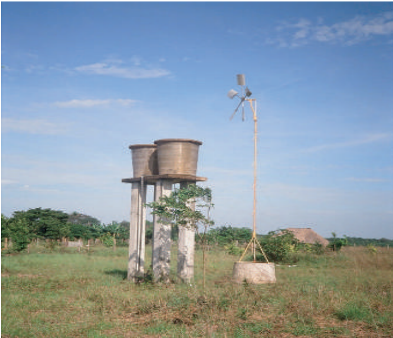
Molino tropical GAVIOTAS de doble efecto para elevación de agua
