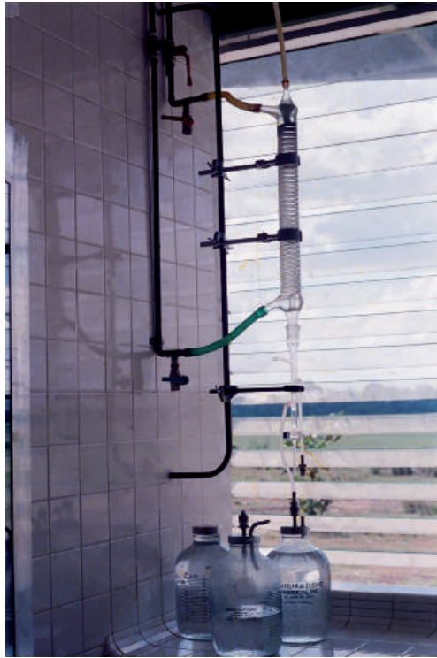
Destilador solar de agua GAVIOTAS
