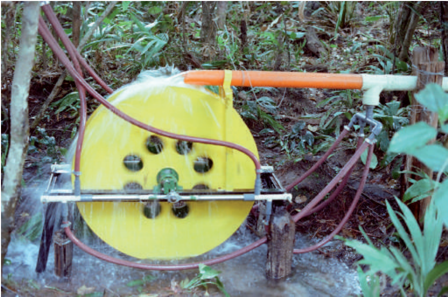
Rueda hidráulica GAVIOTAS para elevación de agua
