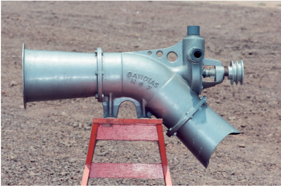
Microturbina hidráulica GAVIOTAS de filo de agua de 1 kw
