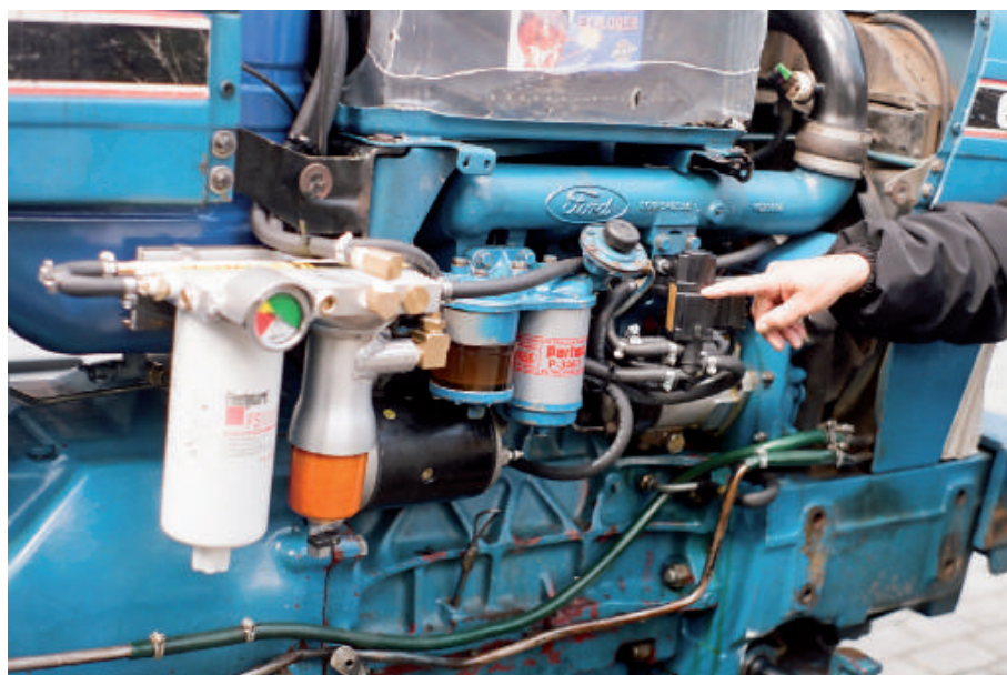
Aspecto de un tractor que opera con aceite crudo de palma africana para lo cual se le adicionó un kit exterior de calentamiento de aceite
