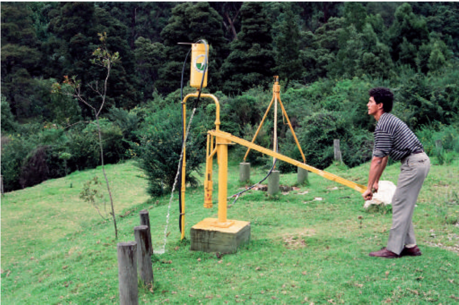
Bomba GAVIOTAS de control remoto para elevación de agua
