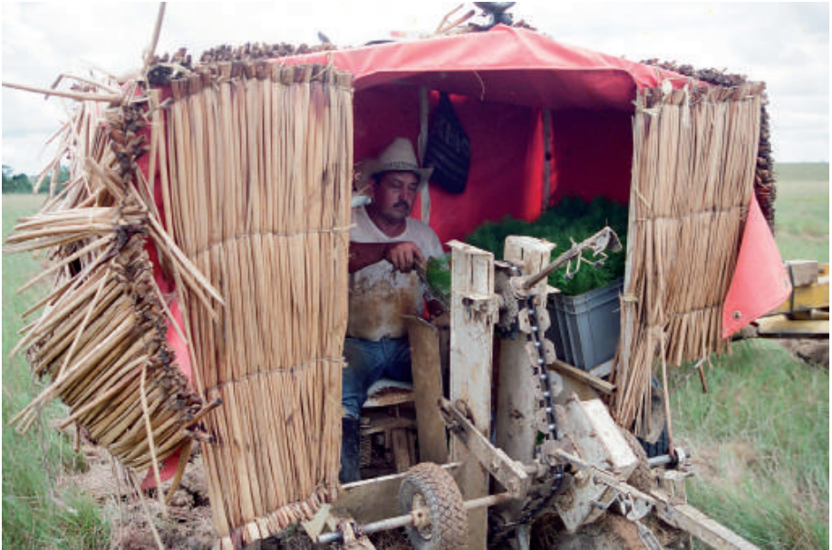
Detalle de plantadora GAVIOTAS con labranza mínima para pino tropical caribe
