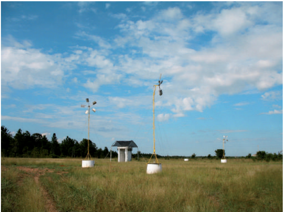
Extracción de agua natural tropical GAVIOTAS por molinos de viento de doble efecto ubicados encima del manantial
