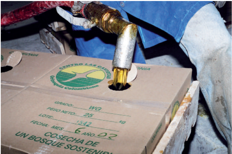
Detalle del llenado de colofonia en cajas de cartón, a 150° centígrados, en GAVIOTAS
