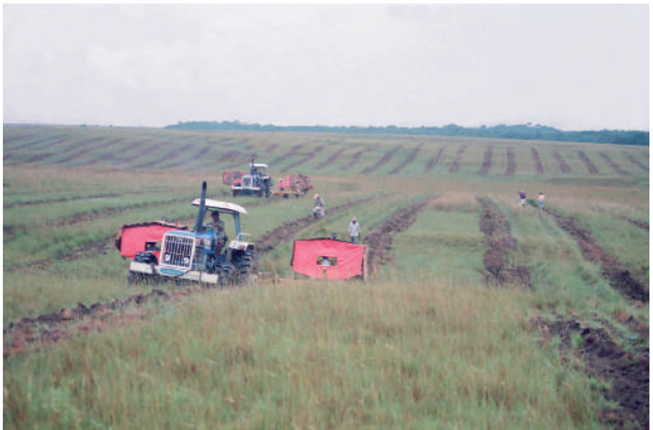
Plantadoras GAVIOTAS de pino tropical caribe en sabanas del Vichada con labranza mínima
