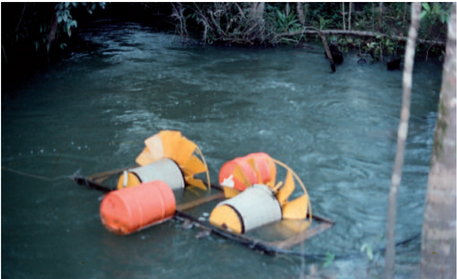
Bomba hidrostática GAVIOTAS para elevación de agua
