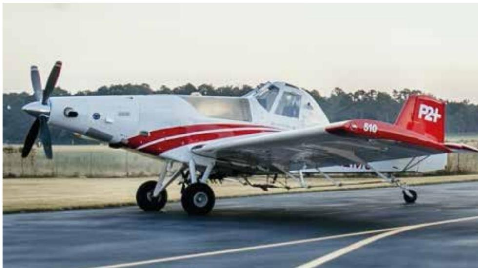
Pistas curtas, grandes altitudes e dias quentes não são problema para o novo 510P2+. Agora com um PT6-140AG e uma hélice de 4 pás instaladas na melhor versão do Thrush 510 Airframe, esta aeronave pode lidar com qualquer coisa.
