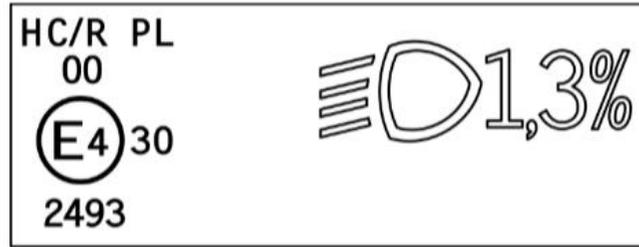
Figura D2 Ejemplo identificación faro tipo ECE
