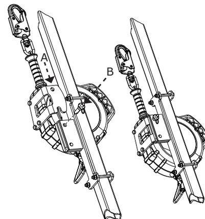
Installez le support de montage sur le dispositif SRL avec récupération Rebel pour une utilisation sur le trépied DBI-SALA KM1PT7, KM1PT9:
