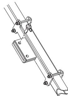
Figure 2 - Installation du support compatible sur le trépied Protecta
