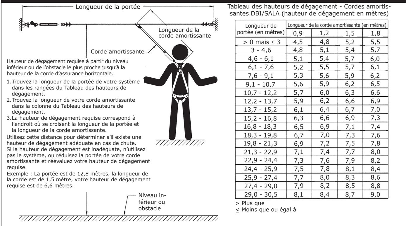
**Figure 9 – Évaluation de la hauteur de dégagement lors de l'utilisation de cordes d'assurance autorétractables DBI-SALA**
