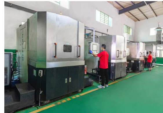
多线切割机 Multi wire cutting machine
