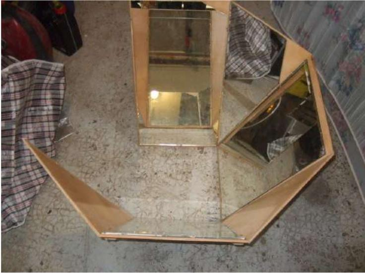
Una vez que se ha atornillado las 16 piezas guía de madera, ahora se tiene una manera de conectar fácilmente los reflectores entre sí: ¡Atornillar las piezas guía juntas desde un lado!
