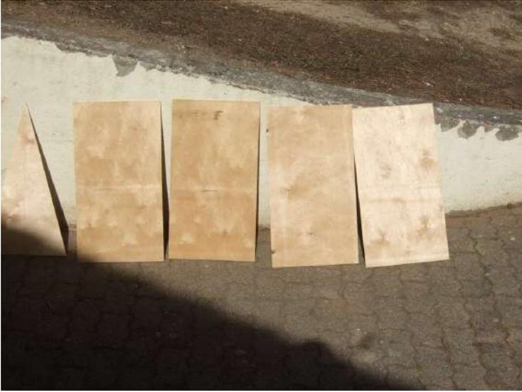
Fabricar 8 reflectores, 4 de ellos rectangulares y los otros 4 triangulares, contando de la madera contrachapada de 8 mm de espesor en dimensiones que ahora especificaremos.
