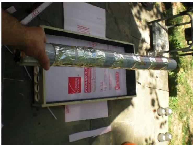
Cada tubo de lata debe tener la misma altura. En el caso de la caja de la demostración, cada uno de los ocho tubos tiene 9 latas de altura. Usar la cinta aluminio autoadhesiva para ensamblar las latas en tubos, luego pintar el conjunto de latas con pintura en spray negra mate. Asegúrese de que las latas no lleguen hasta la parte superior o inferior, debe existir una pequeña cámara en la parte superior e inferior del colector para recolectar y expulsar el aire.
