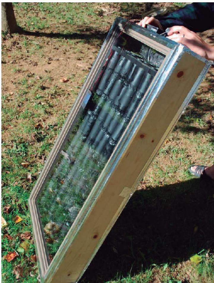
Cuando hay sol, independientemente de la temperatura exterior, la radiación que incide sobre las latas de aluminio hace que estas se calienten muy rápidamente. Luego, unos ventiladores pequeños instalados en el sistema impulsan el aire frío desde el interior de la casa, a través de las latas calentadas y luego lo regresan a la habitación.
