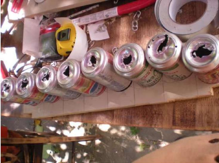
Una vez lijadas las latas, se debe planificar la matriz. Coloque las latas una al lado de la otra a lo largo del tablero inferior, dejando un pequeño espacio entre cada una. Dibuje el contorno de las latas en el tablero inferior para hacer el primer colector. Proporcione suficiente espacio desde cada borde para asegurarse de que la tabla no se rompa al cortar los agujeros del tamaño de las latas. Use la broca para agujeros de 2 y 5/8 pulgadas para este trabajo. Luego, utilice cinta
