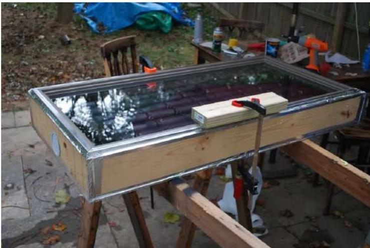
Después de probar el ensamblaje final, ahora puede terminar la caja. Instale las rejillas de ventilación superior e inferior en los orificios pre-taladrados.
