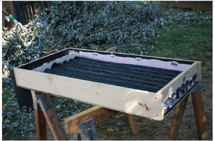
Se debe tener especial cuidado en este paso ya que una manipulación brusca romperá los sellos de cinta en los tubos de las latas. El ensamblaje final debe tener perforados los orificios de las tablas superiores e inferiores y tener instalados los conductos de ventilación.
