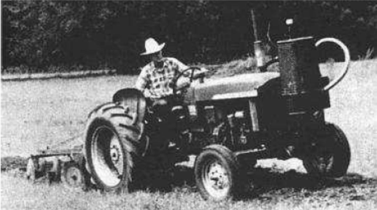
Esto fue hecho extensivamente durante la segunda guerra mundial cuando la gasolina estaba en la fuente corta. Esto se puede hacer quemando el combustible sólido en el aire insuficiente, produciendo el hidrógeno, el monóxido de carbono y el metano que pueden ser quemados en un motor de combustión interna:
