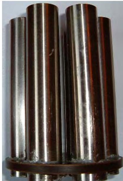
**Mientras que Stanley Meyer utilizó los tubos largos de 15 pulgadas (300 milímetros) de acero inoxidable (que él describió engañosamente como tubos de la "aleación"), Dave utilizó las pipas de cobre de solamente seis pulgadas en longitud.**
