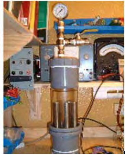
**Esta célula de división de agua utiliza pares de electrodos tubulares dispuestos en pares, uno dentro del otro:**
