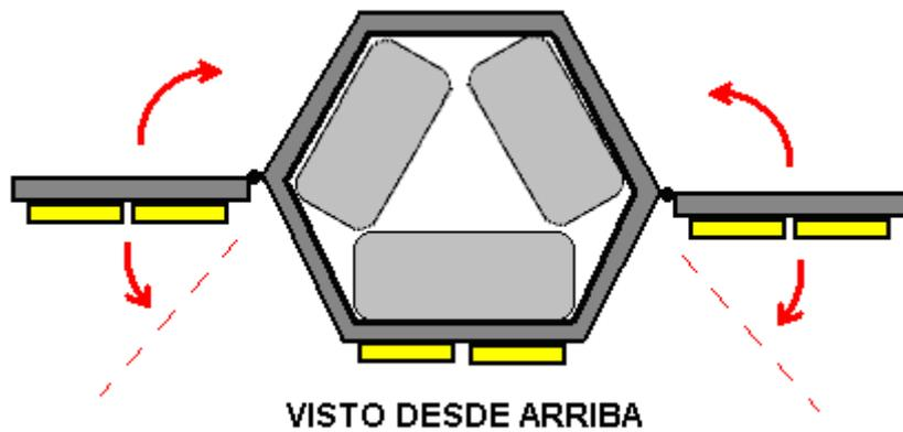
Esto da una forma compacta hexagonal que es fuerte y que tiene las mismas capacidades versátiles de la iluminación. Los lados se extienden por encima de la parte superior y debajo de la base para que la unidad se pueda colocar de forma segura en una superficie horizontal plana. Las bisagras deben estar rígidas de manera que mantengan su posición cuando estén ajustadas al ángulo deseado. Cada panel puede tener una, dos o tres matrices de LED montados en él.
