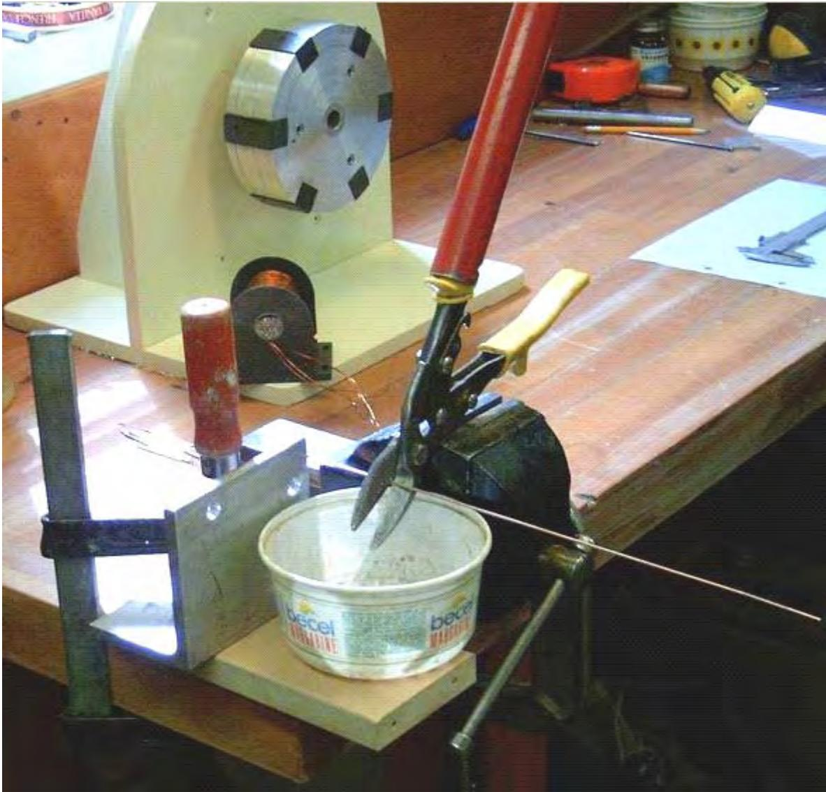
La distancia entre los esquileos y el metal afianzado con abrazadera al Banco de trabajo hace cada longitud del corte del alambre exactamente el tamaño requerido, mientras que el envase plástico recoge los pedazos del corte listos para la capa con la laca clara o con poliuretano claro antes de uso en la bobina Núcleos.
