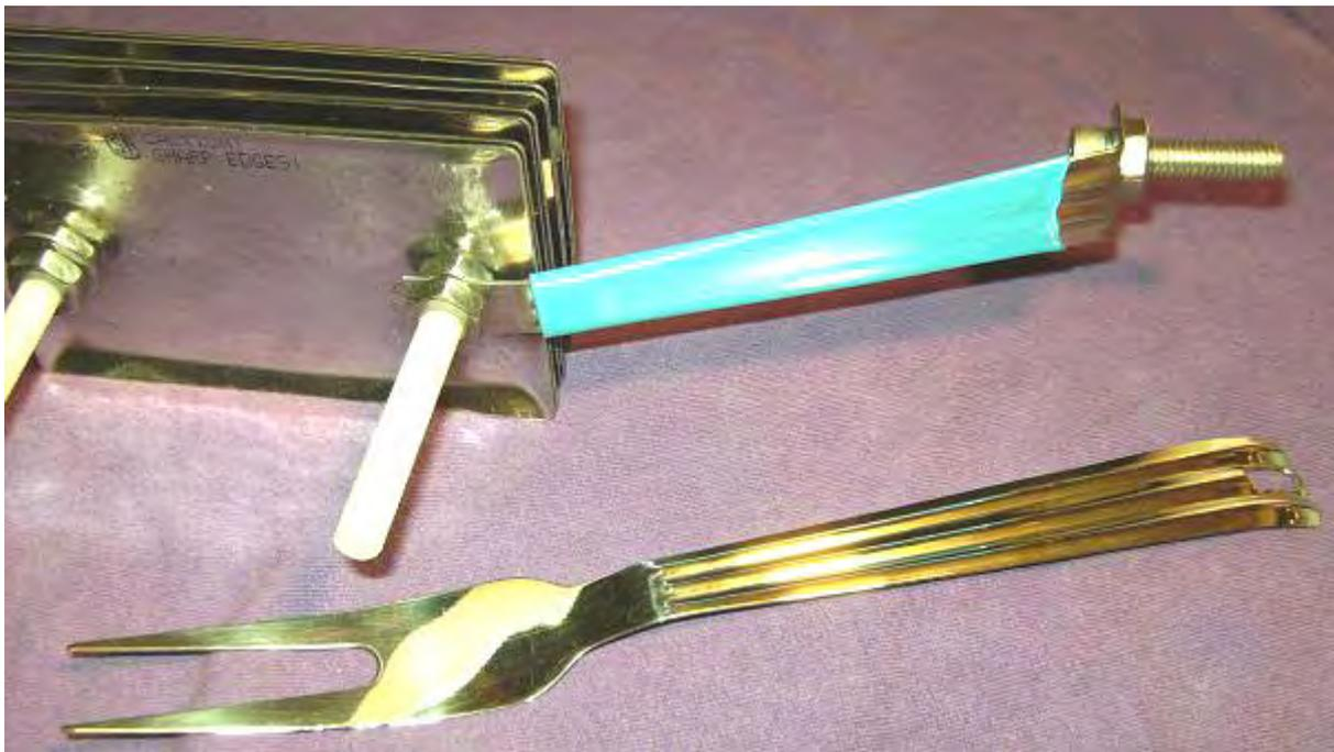
Las placas se limpian y se enarenan cuidadosamente y se perforan exactamente:
