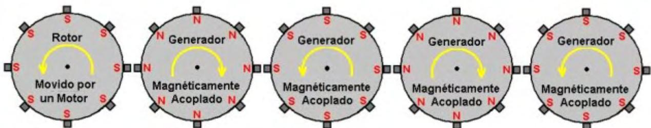
Las hileras de imanes se inclinan en direcciones opuestas en cada rotor para que coincidan perfectamente, imán en imán en cada hilera:
