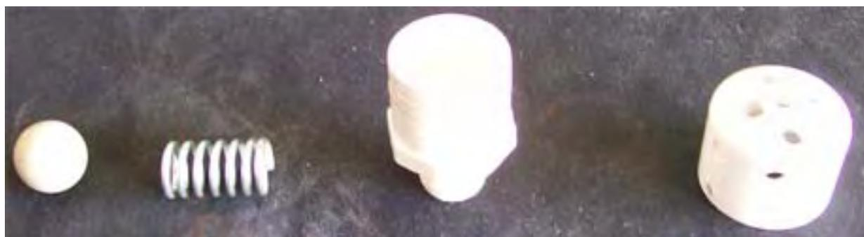
La tapa es perforada con orificios y estos componentes se ensamblan para producir una válvula de liberación de presión:
