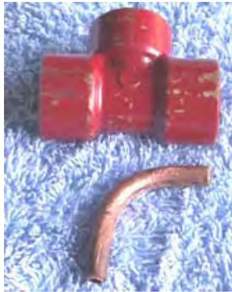
La tubería de cobre se calienta con una antorcha de gas de plomero y se dobla muy despacio y con cuidado a la forma indicada arriba. Algunas personas encuentran útil insertar una longitud de material flexible adecuado, (como el material de resorte de acero en espiral utilizado para soportar las cortinas netas), antes de comenzar la flexión, ya que ayuda a evitar que la tubería de cobre se tuerza al doblarse.
