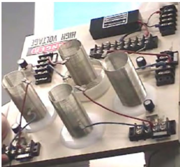
Aquí, la bobina central es el transmisor con la bobina primaria bien encima de la bobina secundaria. Las tiras negras son solamente conectadores industriales del tornillo del grado. Las tres bobinas más cercanas son tres bobinas idénticas del receptor a las distancias idénticas de la bobina del transmisor. Cada bobina del receptor tiene un condensador y un condensador pequeño ajustable para afinar exacto. La bobina del transmisor Tesla es conducida por un módulo del conductor del tubo de neón:
