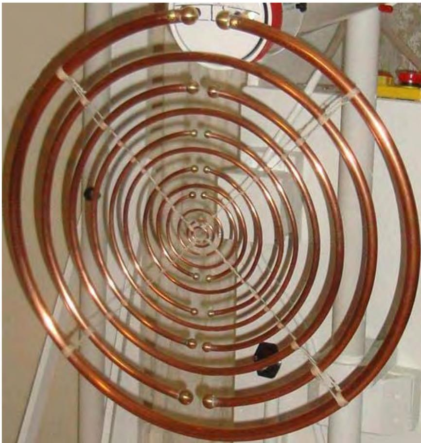
**Las dos antenas se construyen de la pipa de cobre flexible disponible de China.**
