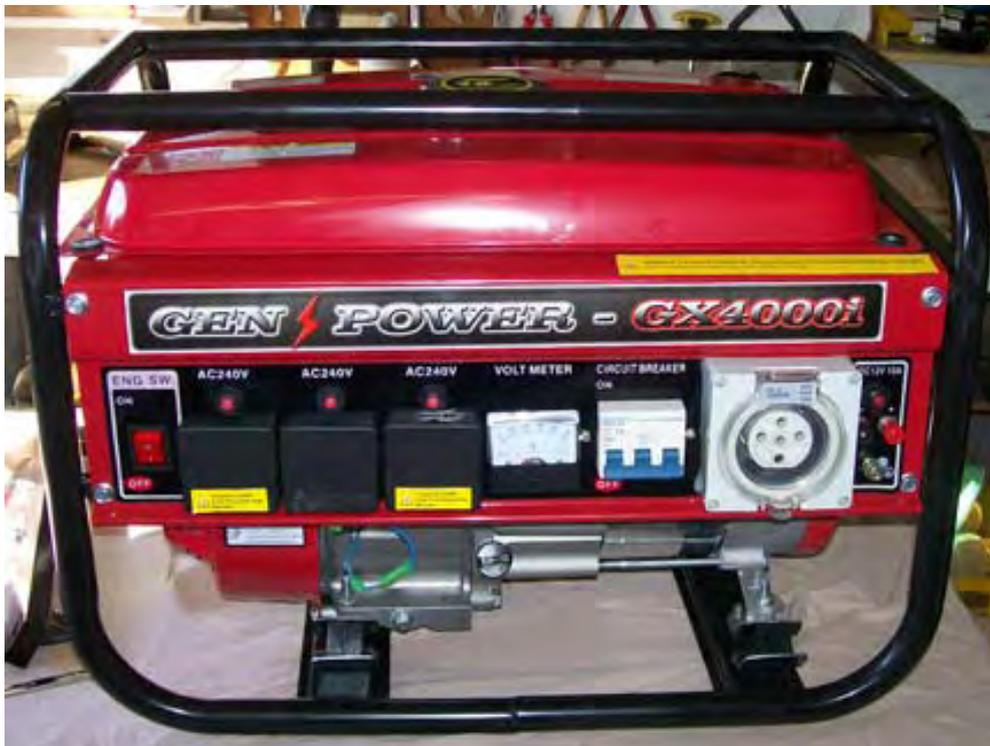
El primer paso de la conversión es quitar el depósito de combustible que se mantiene en su lugar por cuatro pernos, y que da acceso al carburador que se retira, ya que no se utilizará:
