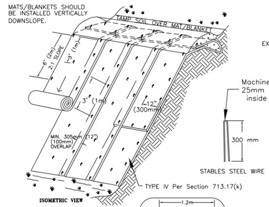
**TYPICAL SLOPE SOIL STABILIZATION**
