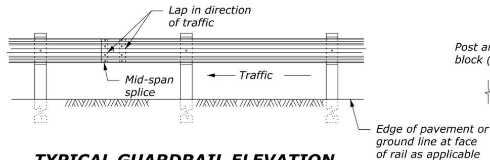
**TYPICAL GUARDRAIL ELEVATION**
