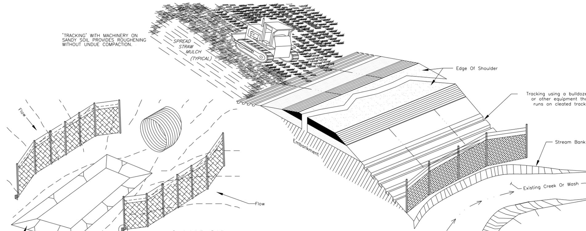
**EROSION & SEDIMENT CONTROL FENCE
