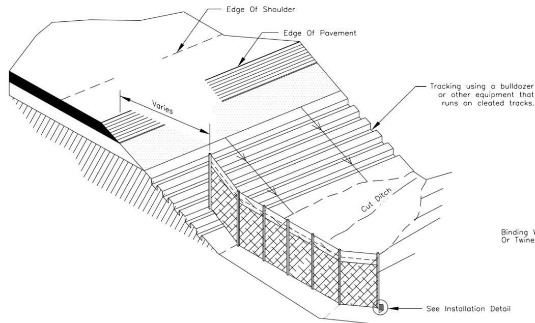
**EROSION & SEDIMENT CONTROL FENCE
