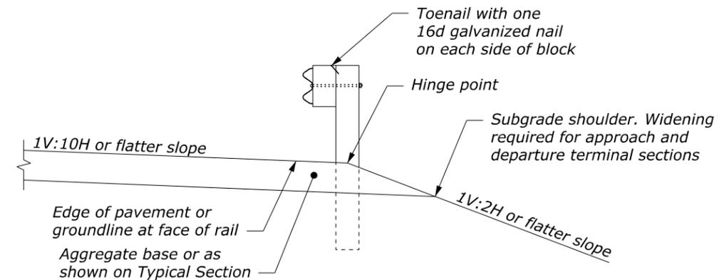
**TYPICAL GUARDRAIL CROSS SECTION**
