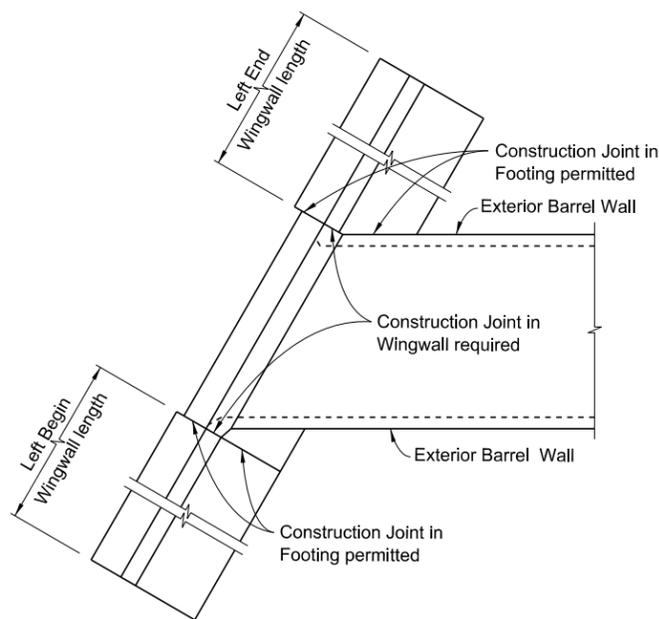
PART PLAN SHOWING PARALLEL WINGWALLS AND LOCATION OF CONSTRUCTION JOINTS
