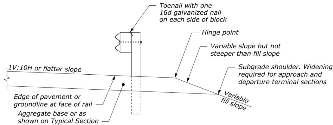
**TYPICAL GUARDRAIL CROSS SECTION**
