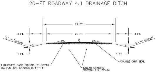
TYPICAL ROAD SECTION 20-FT ROADWAY 4:1 DRAINAGE DITCH
