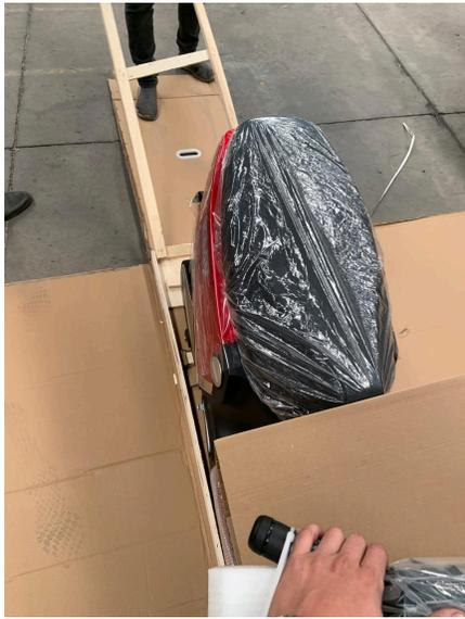
**3- Colocar el caballete en la moto y poner una base debajo de la moto para armar la llanta delantera de buena manera:** Para poder armar la moto de correcta manera y evitar accidentes se tiene que poner lo más estable posible, por eso recomendamos poner la moto sobre su caballete y además colocar una base que no raspe o dañe la tapa debajo de la moto para así tener levantada la parte delantera
