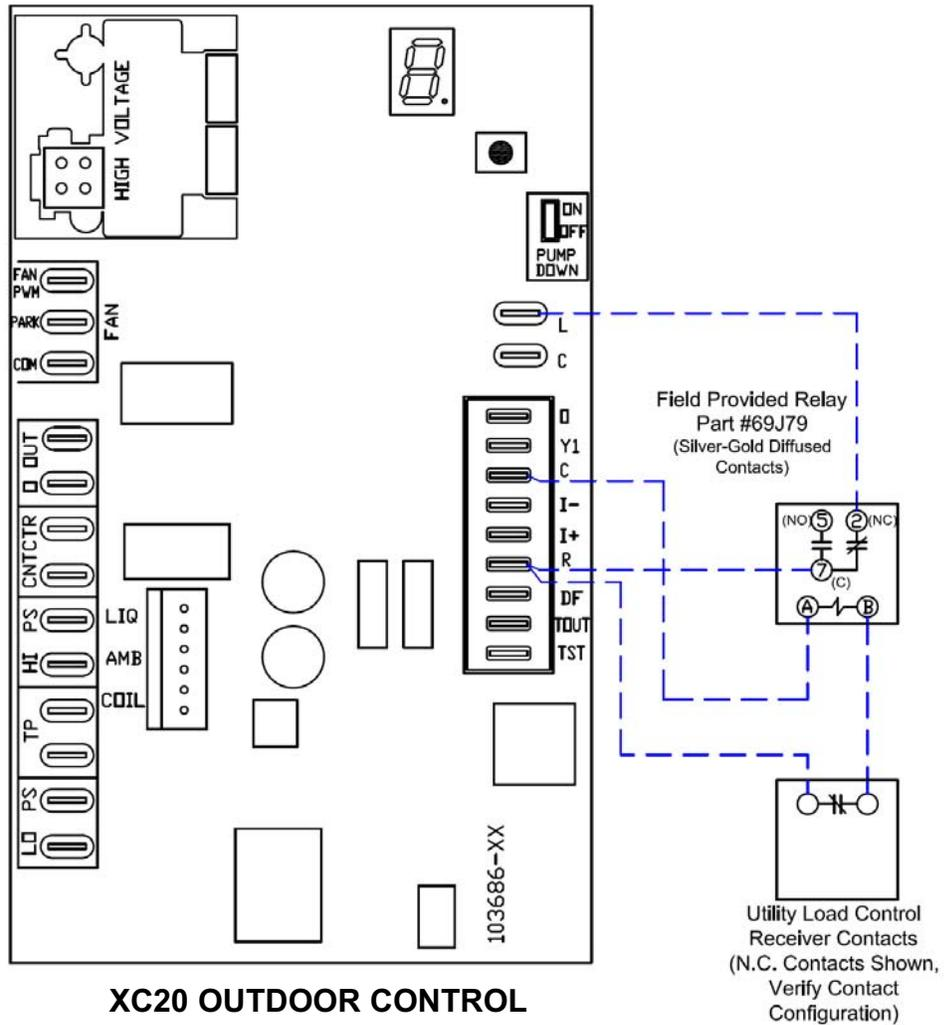
**Figure 24. Load-Shedding Feature Wiring Diagram**
